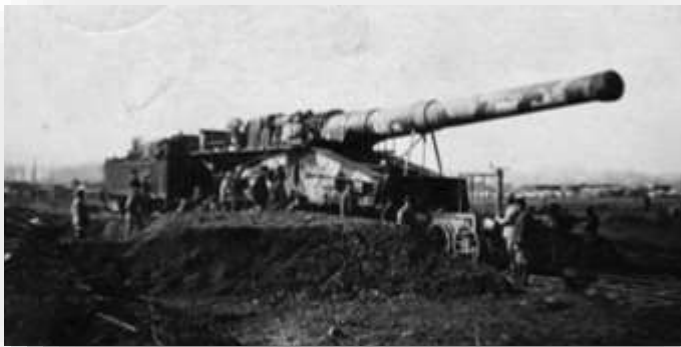
Canon à longue portée de l'armée allemande sur voie ferrée : 340 mm
